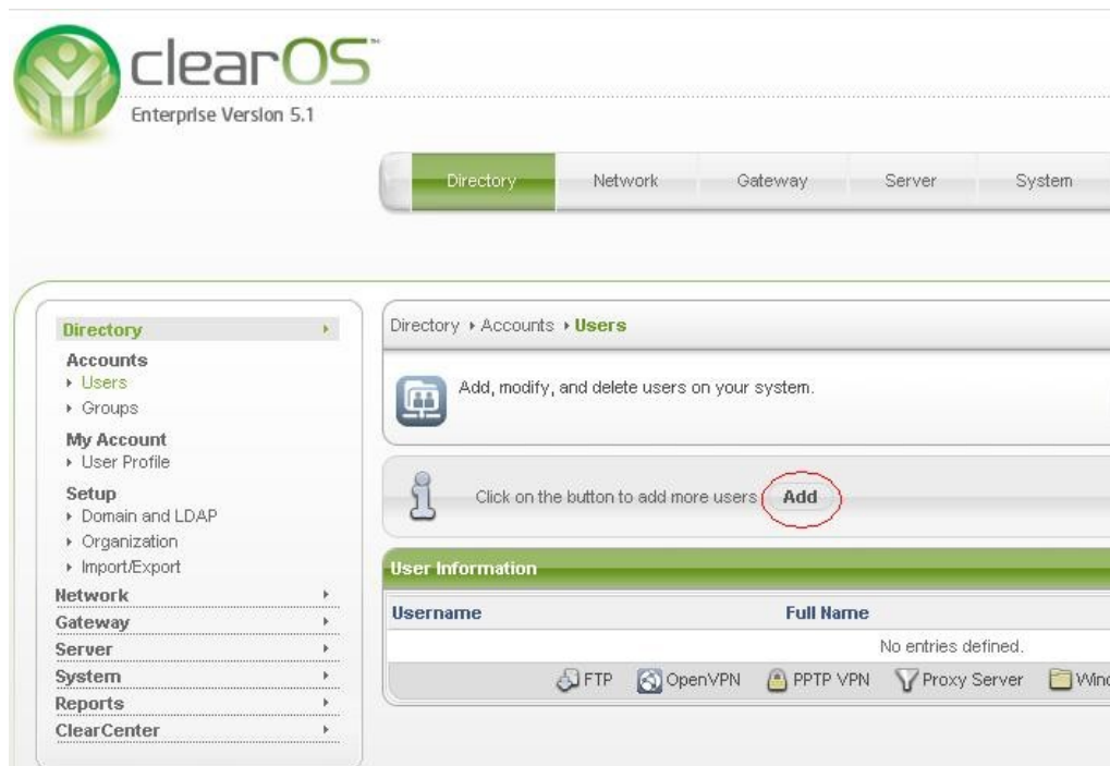
Gambar 40. Penambahan User pada System ClearOS
